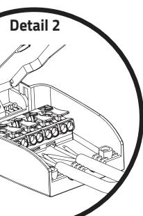
Nehmen Sie den Deckenausschnitt sofern nicht bereits vorhanden gemäß der technischen Zeichnung des entsprechenden Glan Models vor. Legen Sie die Leitung entsprechend Detail 1 bzw. 2 unter Beachtung der Polarität vor.
