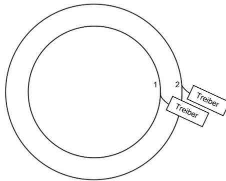
Multipower (Leitungsschutzschalter: B 16A max. 18 Treiber / C 16A max. 30 Treiber)
